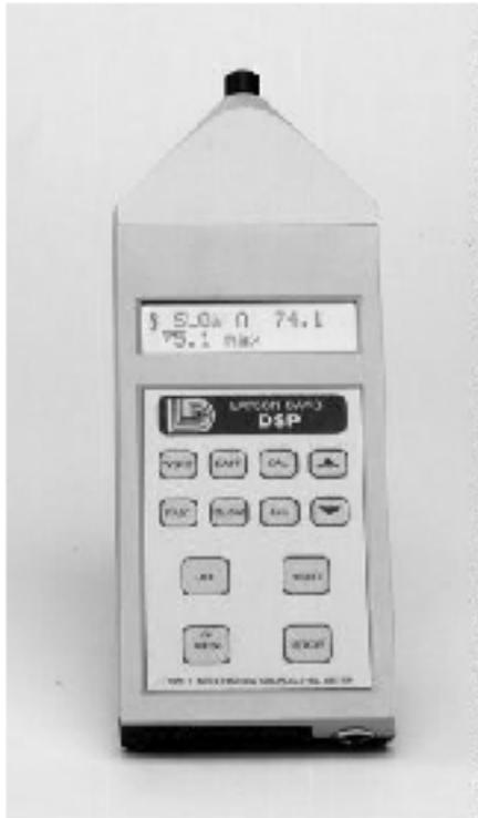
*Fonometro integratore in classe 1. Lo strumento è in grado di misurare il livello equivalente in dB(A) (Larson&davis)*
