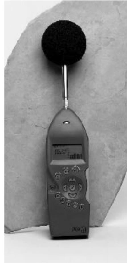
*Fonometro analizzatore integratore in classe 1. Lo strumento è in grado di eseguire l'analisi in frequenza parallela in banda di ottava (16 Hz - 16 KHz) (Larson&davis)*
