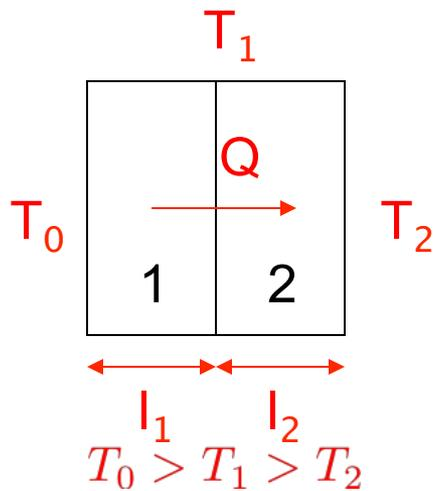
Se  $T_0$  e  $T_2$  sono fissate, il flusso di calore è uguale nei due corpi:
