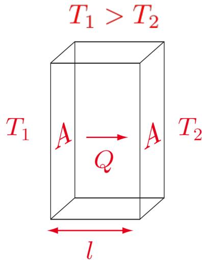
Il flusso di calore tra la faccia a  $T_1$  e quella a  $T_2$  è:
