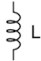
L'unità di misura dell'induttanza è detta henry:  $1 \text{ H} = 1 \text{ Wb} / 1 \text{ A}$ , in onore di Joseph Henry. In un induttore di 1 henry, quindi, una variazione di corrente di 1 ampere al secondo genera una forza elettromotrice di 1 volt.
