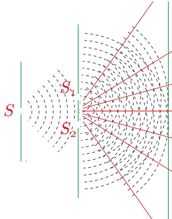
La (piccola) fenditura  $S$ , colpita da un raggio monocromatico (ottenuto con un prisma), agisce, in base al principio di Huygens, come una sorgente puntiforme. Le due (piccole) fenditure  $S_1$  e  $S_2$ , colpite da quest'onda sferica, agiscono a loro volta come due sorgenti puntiformi coerenti. Le linee rosse rappresentano i luoghi dei punti di interferenza costruttiva.
