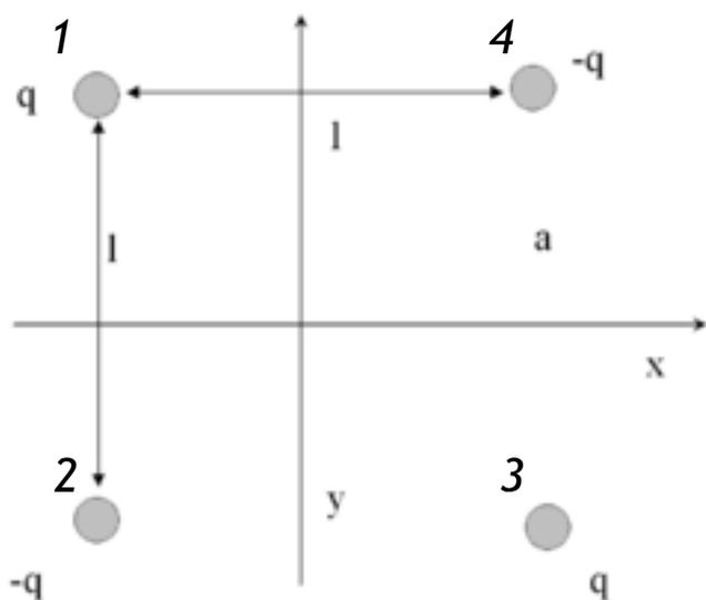
Sull'asse  $x$  solo la componente  $y$  del campo elettrico è diversa da 0.
